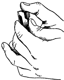
Рис. 19. Отделение выбрасывателя от остова затвора
